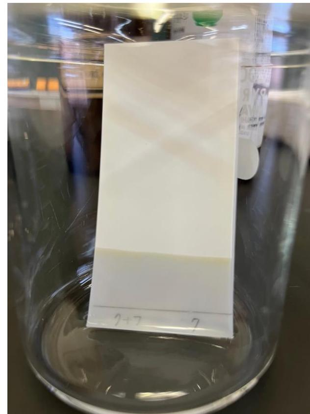
図20 シリカゲルTLC板を用いた展開の様子
